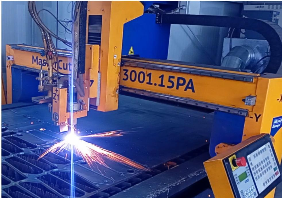
Fast alle Anschweißrahmen werden bei uns maschinell gefertigt.
